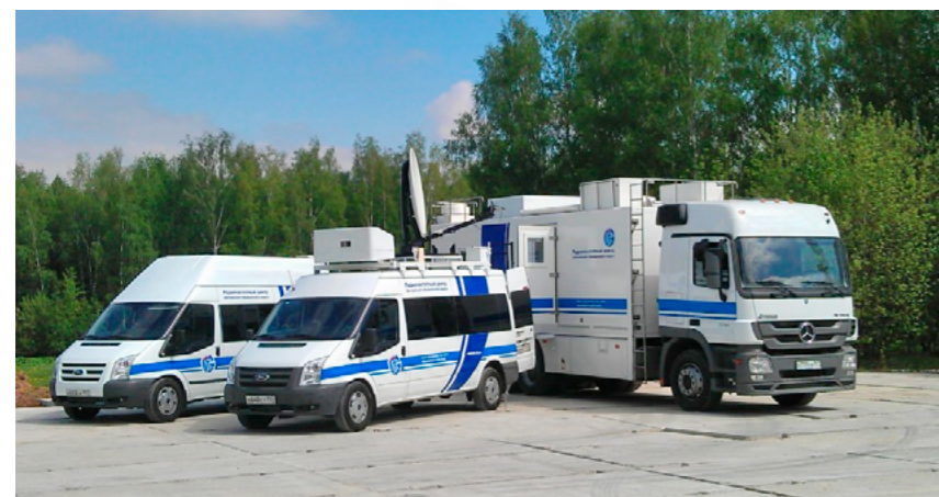
Современные мобильные комплексы радиоконтроля ППРКУС, «Барс-МПИ2М, МКСРК
