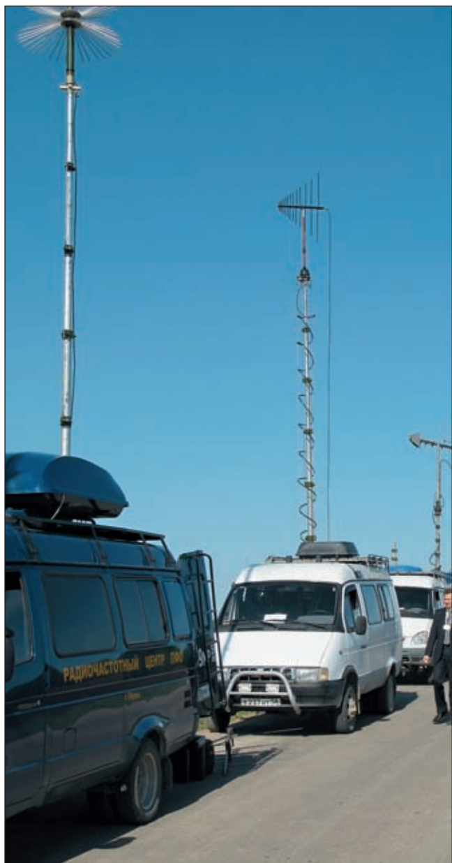
Проведение измерений параметров излучения радиоэлектронных средств мобильными комплексами радиоконтроля
