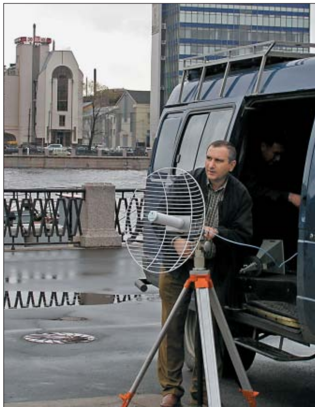
Измерение параметров излучения РЭС госинспекторами управления по Санкт-Петербургу и Ленинградской области
